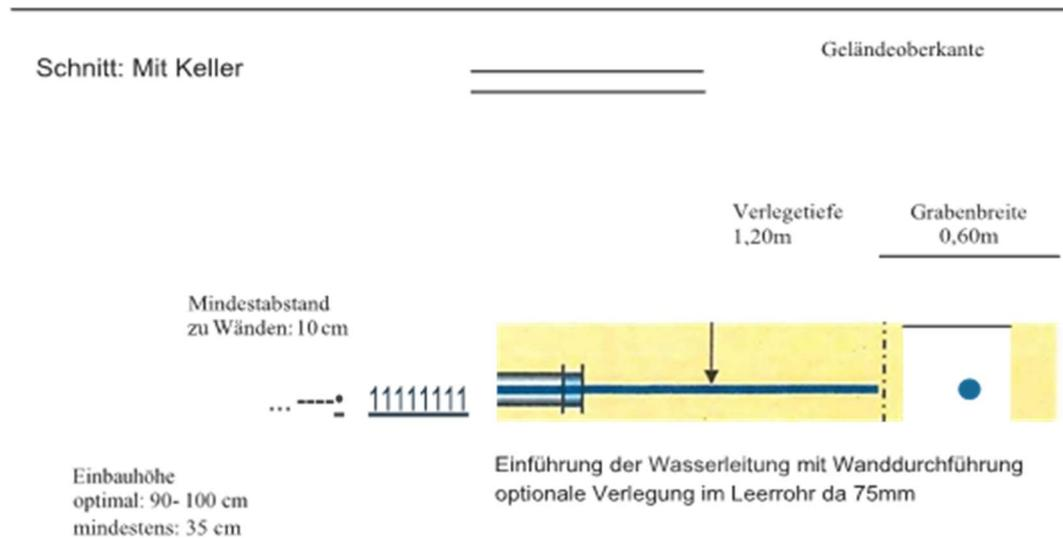
Abbildung 2: Schematische Darstellung der Hauseinführung mit Keller
