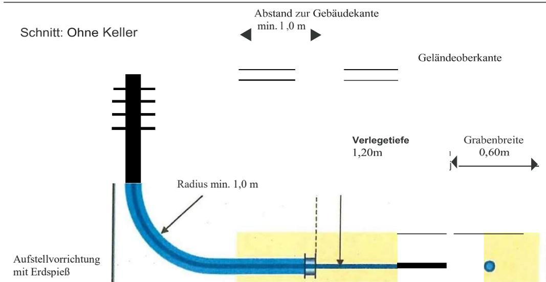
Einführung der Wasserleitung mit flexibler Hauseinführungskombination
